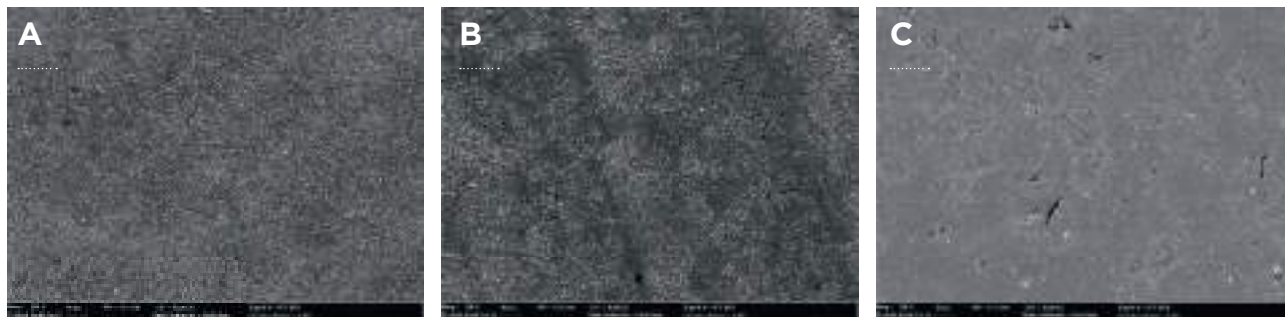
Imagem 01: Imagem de microscópio eletrônico de varredura (FE-SEM) com ampliação de 500x, demonstrando microestrutura dos materiais. (A) VOXELPRINT CERAMIC, (B) Concorrente 1, (C) Concorrente 2.
