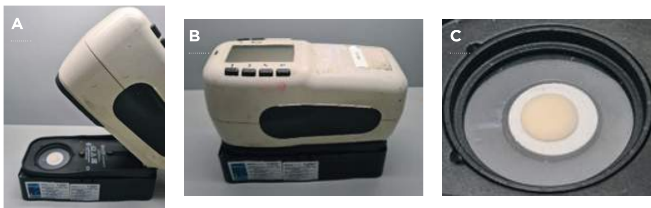
Imagens A, B e C: Equipamento de espectrofotometria utilizado para medição de cor dos corpos de prova.
