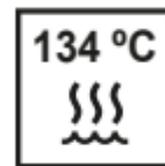
Indica a temperatura máxima para esterilização em autoclave.
