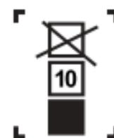
Índica a quantidade máxima de caixas que podem ser empilhadas no transporte e armazenamento.
