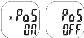
Figura 8: Configuração da posição de medição do monitor de pressão
