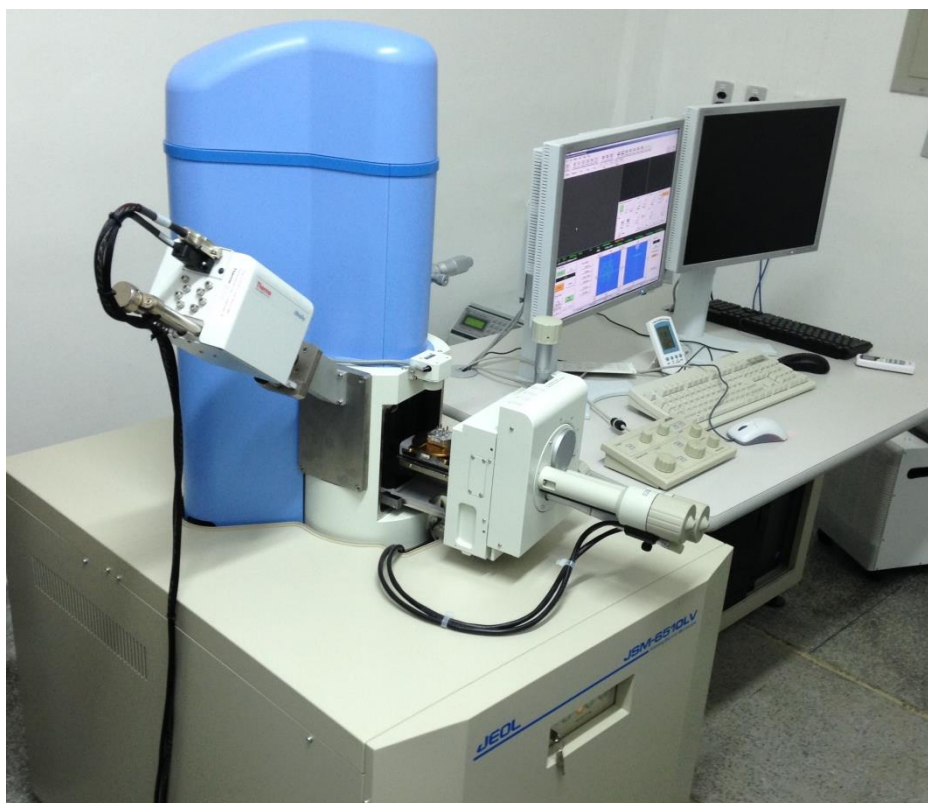
Figura 10: Microscópio eletrônico varredura JEOL JCM-5700 CARRY SCOPE (Jeol-USA).
