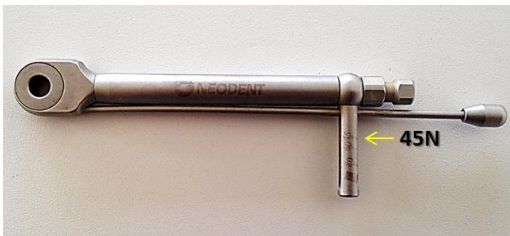
Figura 6: Torquímetro cirúrgico manual
