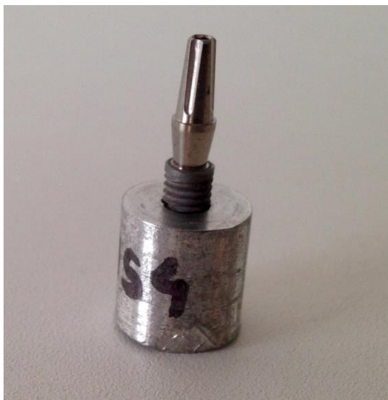
Figura 5: base, em alumínio, com implante e abutment instalados
