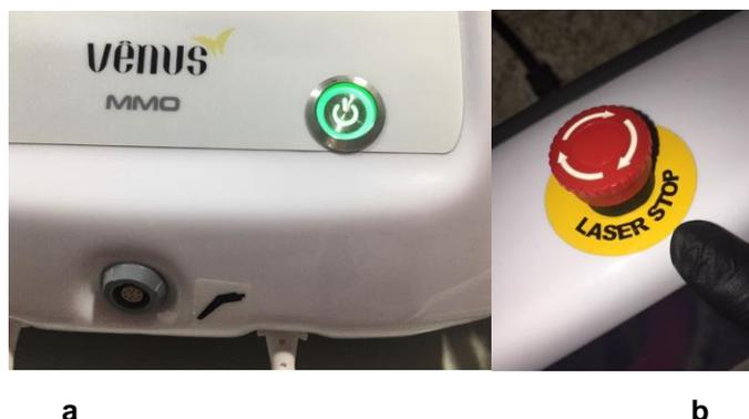
**Figura 2 - Entrada auxiliar dianteira para acoplamento de uma manopla extra (à esquerda) e chave “stand by” na parte dianteira (à direita); e, chave de emergência no topo do equipamento “Laser Stop”.**
