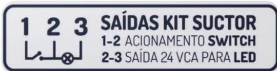
**1 e 2** – Acionamento da Suctron através das micro chaves localizadas no suporte do Kit Suctor/unidade auxiliar.
